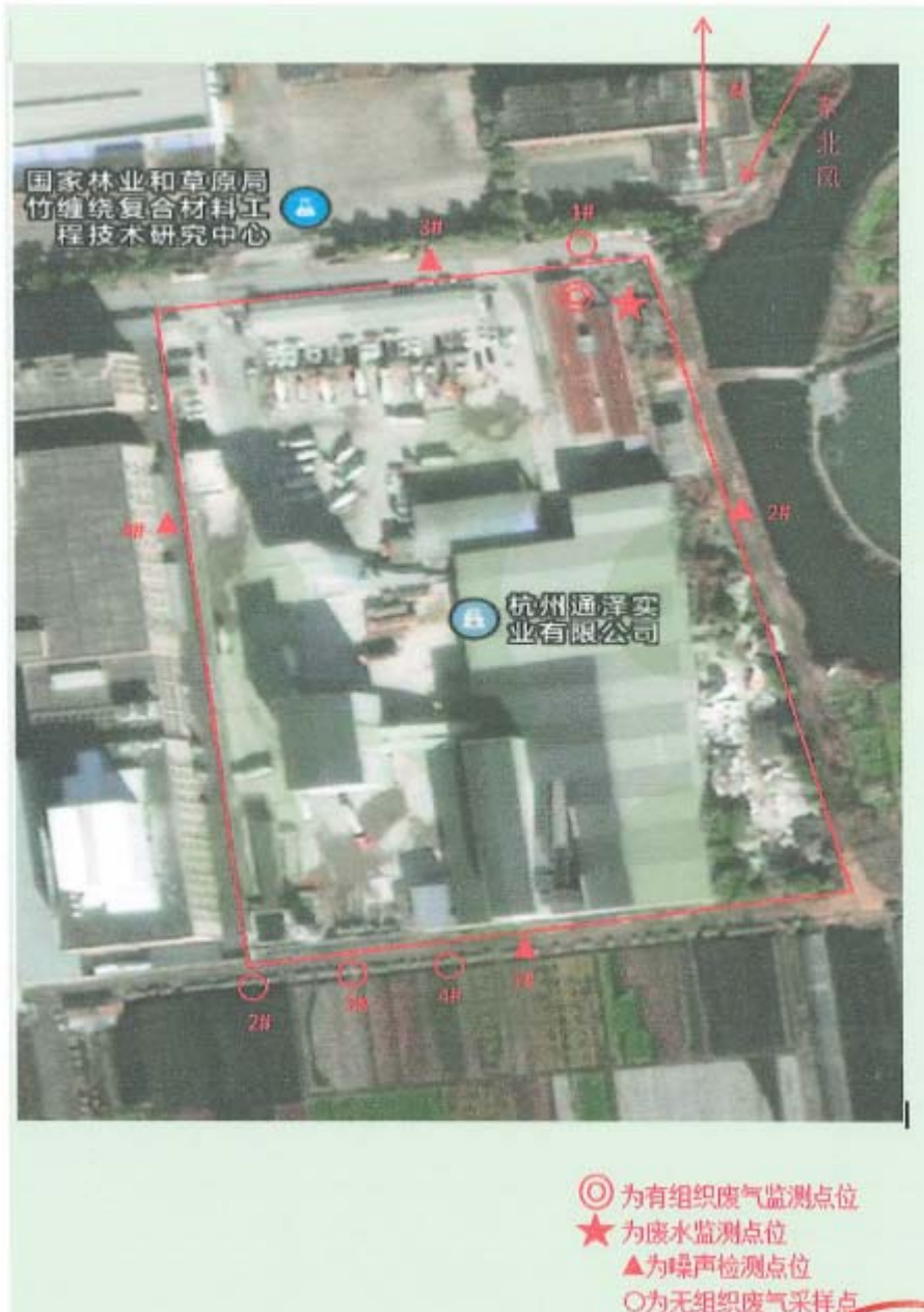
图 7-1 废水、废气、噪声监测点位图
